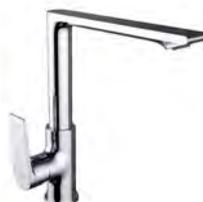
**Monomando** fregadero. Mezclador con aireador, caño fundido giratorio, flexibles M-10 3/8" x 420 mm con cartucho economizador del 50% de caudal y apertura 100% agua fría para ahorro energético.
