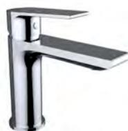
**Monomando** lavabo. Mezclador con aireador y flexibles M-10 3/8" x 420 mm. con cartucho economizador del 50% caudal.
